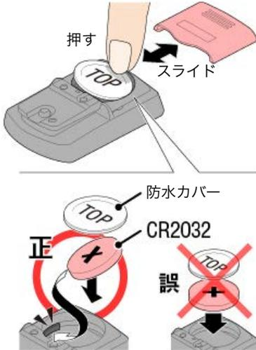
※ 防水カバーは、カバー上部のふちを押して取外します。
